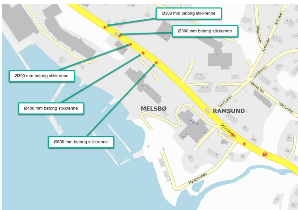
Figur 2-4 Stikkrenner under fylkesvei 8240, søndre del (vegkart.atlas.vegvesen.no)
