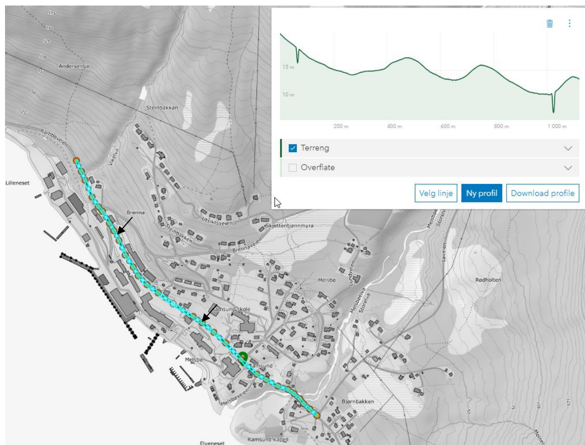
Figur 2-7 Lengdeprofil av Strandveien mellom Vikelva og Melsbølva. Pilene viser to markerte lavbrekk som vil definere flomveier fra ovenforliggende område. (hoydedata.no)
