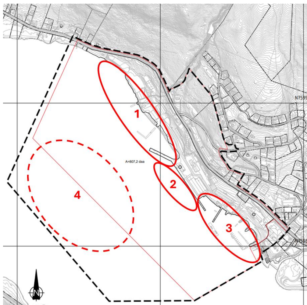
Figur 1-1: Utklipp av planområdet. Lokasjoner hvor det skal legges opp til utfylling er markert med rød heltrukket sirkel. I området med stiplet sirkel er det planlagt forankringsfundametner på sjøbunn.
