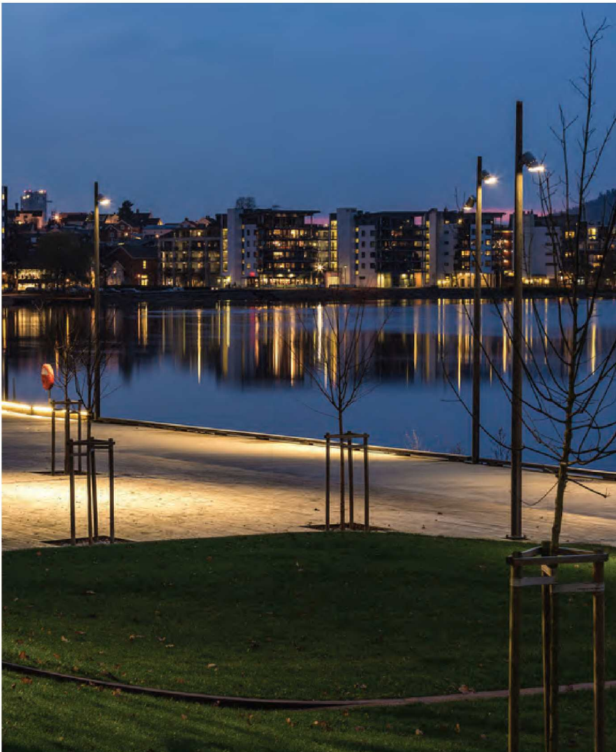
Referansebilde: Lav mast med avskjernet armatur
