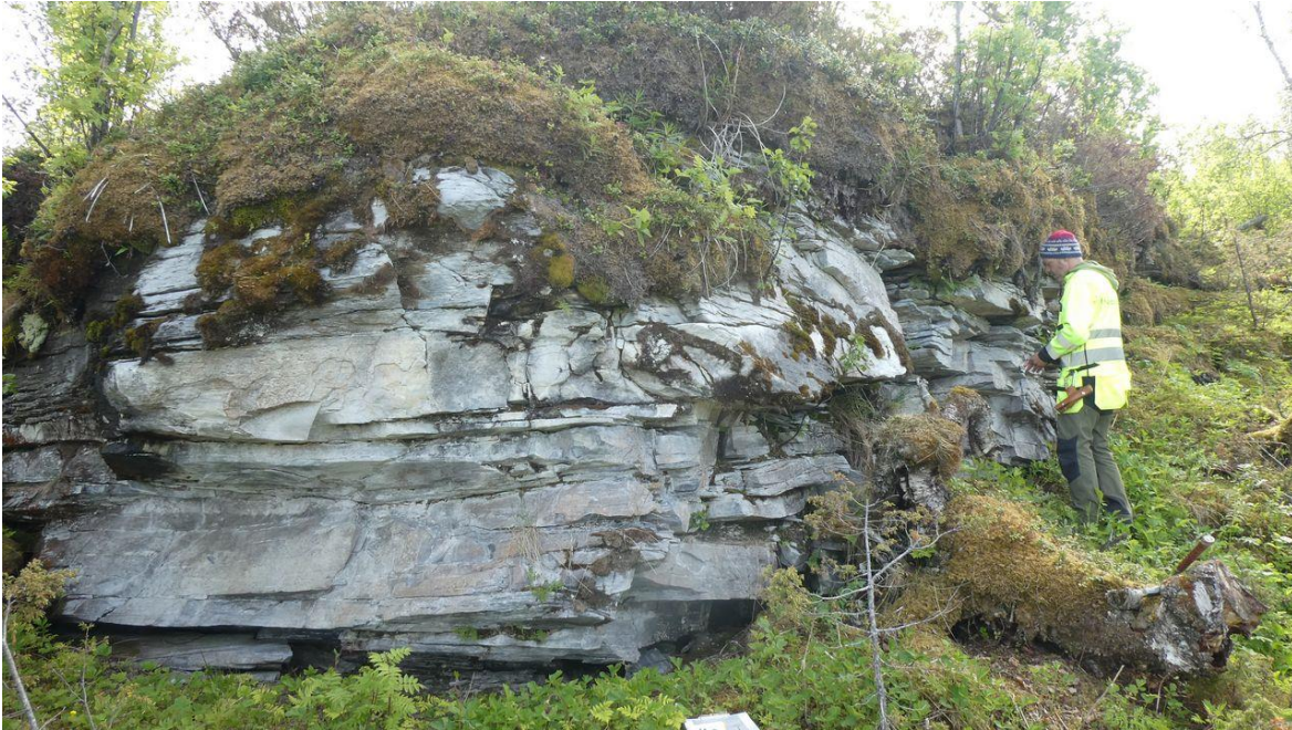
Figur 7: Bergblotning sør for vei (uttaksområde sør) viser kalkspat-bergart med godt utviklet foliasjon. Plassering er vist i Figur 5 (sør-østligste anviste punkt).
